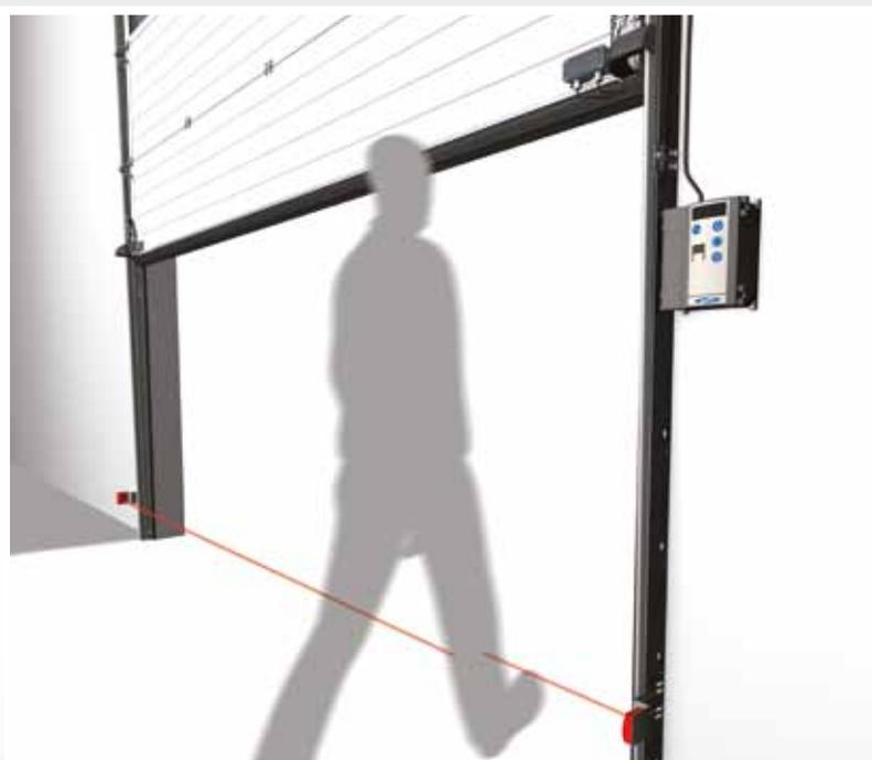
guida di scorrimento del lato in cui si trova l'unità di comando e di un riflettore o un ricevitore sulla guida opposta. Se il fascio che va dal trasmettitore al riflettore/ricevitore viene interrotto, il motore riceve un segnale di arresto e inversione di marcia. A differenza di quello con riflettore, il modello con ricevitore non è sensibile a polvere e umidità.
