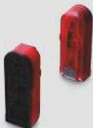
Coppia fotocellule Extra 626 20-28 V, IP 50, 2 fili Distanza max 8 m Per motori Novomatic 423, 553 S, NovoPort. Non possibile in caso di sezionale con molle verticali.
